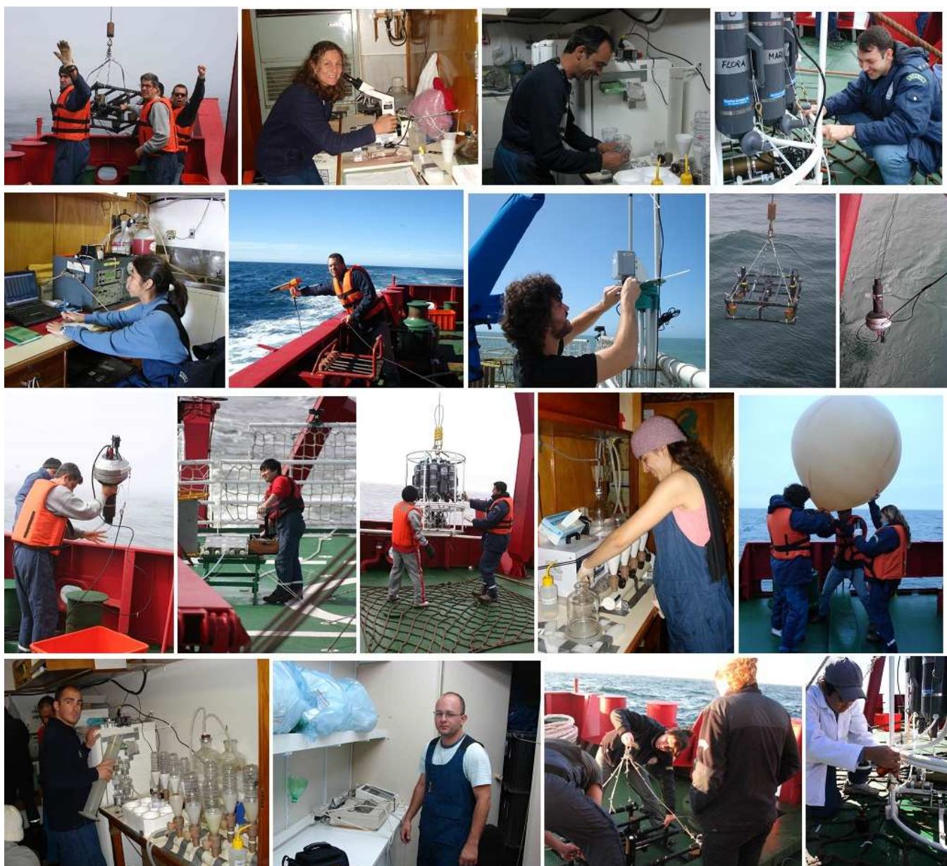
Figura 6. As atividades desenvolvidas durante o cruzeiro (da esquerda para direita): laçamento do radiômetro ótico hiperespectral pelo guincho de bombordo, análises microscópicas, amostragem de gases atmosféricos, coleta de água das garrafas Niskin, leitura de pCO_2 , lançamento de XBTs, fixação da antena receptora de rádio, coleta de dados óticos, incubação para produção primária, lançamento do sistema CTD/Roseta pela popa do Ary Rongel, filtração de água do mar para determinação de concentração de pigmentos; lançamento de radiosondas atmosféricas, análises de nutrientes e trabalho de coleta de água no convés.
