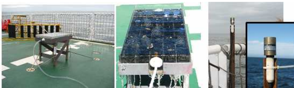
Figura 7. Incubadora de acrílico com circulação de água (esquerda e centro) e sensor de luz visível (direita) no convôo.
