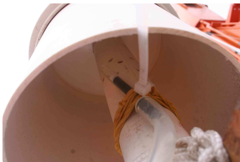
Figura 10. Detalhe da ampola de amostragem de DMS (dimetilsulfeto) instalado dentro do sistema de proteção dos porta-filtro.
